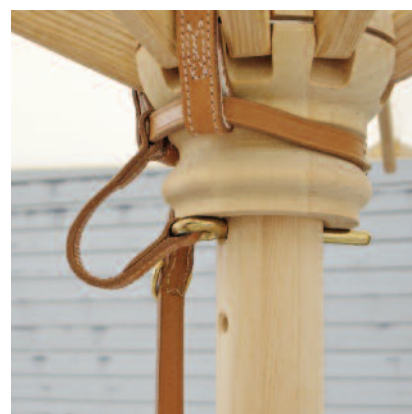
6. Haltestift ganz durch die Bohrung stecken.
